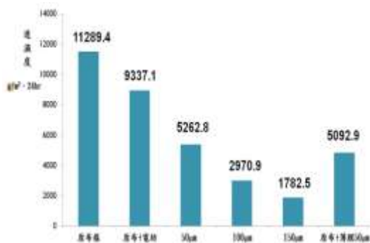
圖19 布樣經電紡與TPU塗佈之狹縫高度不同之透濕度
